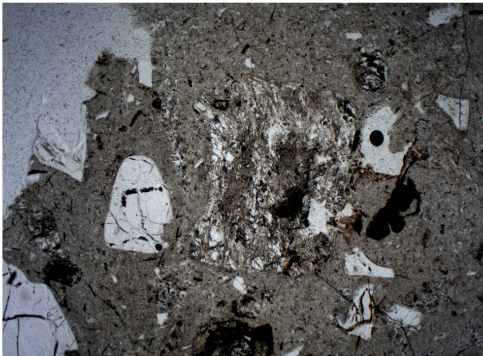
Abb. 5: Zu sehen ist ein alterierter Plagioklas, der saussuritisiert ist. Im Dunkelfeld sind aber noch die für Plagioklas typische polysynthetische Zwillingslamellierung zu sehen.
