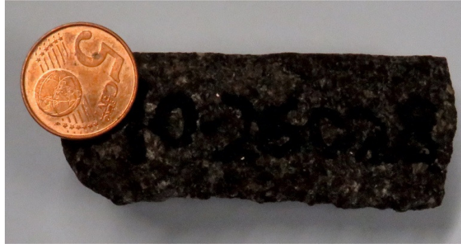
Abb. 1: Makroskopische Ansicht der Probe 10-26028. Das Handstück zeigt eine dunkelgraue, Gesamtgesteinsfarbe. Es lässt sich ein porphyrisches, regelloses Gefüge erkennen, in dem in einer feinkristallinen Grundmasse 2 bis 3 mm große, hypidiomorph ausgebildete Minerale zu sehen sind. (Maßstab: 5 Cent Münze, Querschnitt = 2,0 cm)
